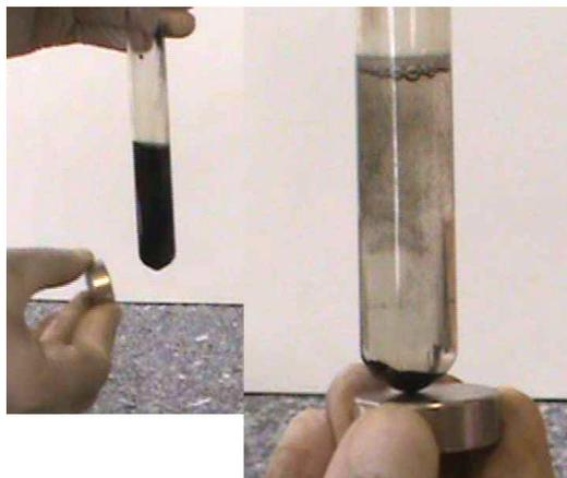
Figura 5 – Avaliação do comportamento magnético da ferrita sintetizada.
